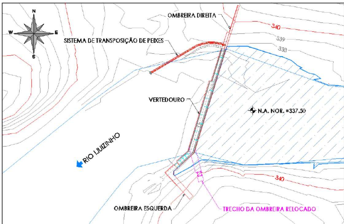
Figura 1: Relocação do vertedouro da PCH Igrejinha
